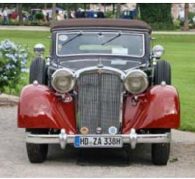
Die noch sehr schlechten Straßen erfordern eine Verbesserung von Straßenlage und Fahrkomfort - Maybach entwickelt die sogenannten „Schwingachswagen“ des Typs SW 35 (1935), SW 38 (1936) und SW 42 (1939 bis 1941) - die Sechszylinder-Reihenmotoren leisteten trotz unterschiedlichen Hubraums einheitlich 140 PS - immerhin gut fünf mal mehr als die ersten Volkswagen...
